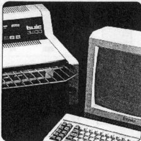
Die Eingabe der Belegdaten und die Mikroverfilmung können mit Hilfe eines an die Kamera angeschlossenen PC durchgeführt werden.
